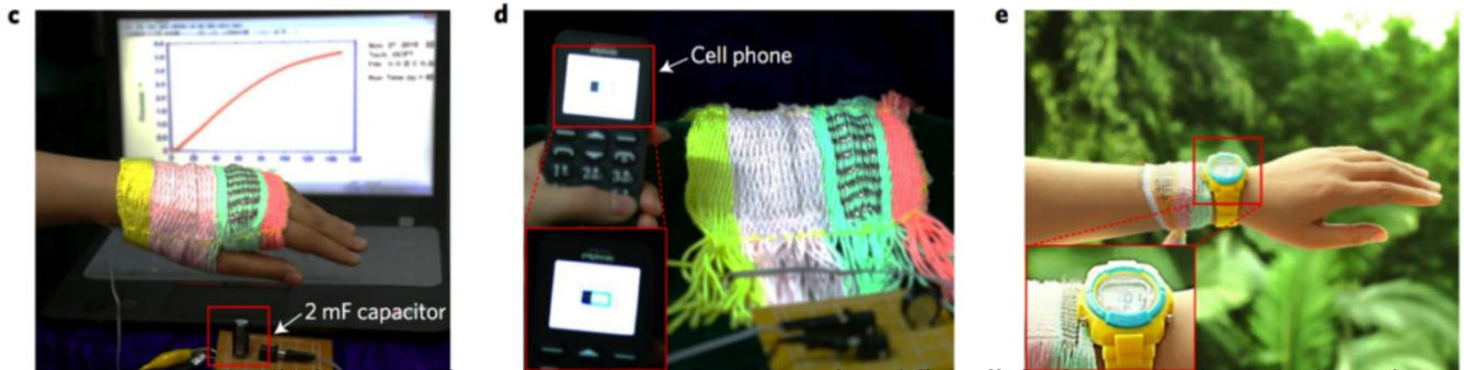
Drei Beispiele für die Verwendung des Textil-Stoffes, einschliesslich dem „direkten laden eines Handys (d) und dem kontinuierlichen Aufladen einer elektronischen Uhr mittels einem tragbaren Gewebe (e).“
